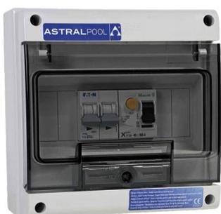
Coffrets en ABS double isolation IP 66 avec porte fumée en façade. Equipés d'un interrupteur différentiel 30mA et d'un disjoncteur courbe D pour une parfaite efficacité de la pompe à chaleur.
