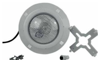
Fabriqué en ABS. Sans niche. Fixation par vis sur la paroi d'une piscine existante. Lampe halogène 100 W - 12 Volts. **Pour piscine préfabriquée à parois minces** (*uniquement pour piscines préfabriquées, panneaux et coques polyester*). **Non compatible avec les cartes Led.**
