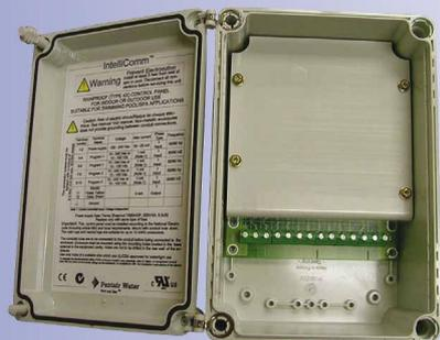
IntelliComm® est un boîtier de commande permettant de relier des applications à la pompe Intelliflow. IntelliComm® enclenche la pompe selon l'application souhaitée et active la pompe à la vitesse préconfigurée.
